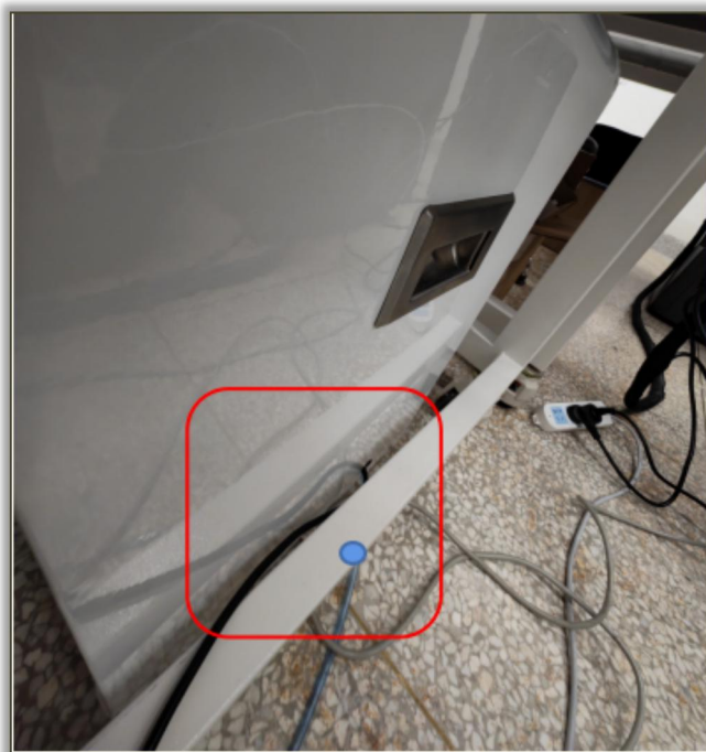
图 9. 空气压缩机背面，电源线及气路线在底部
