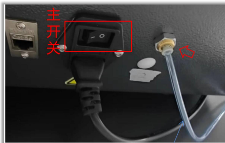
图 10. 右侧外立面电源开关
