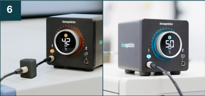
该设备有两种主要配色方案, 通过旋转触摸拨盘周围及相应通道按钮上的发光环来表示。当正在升温或降温至目标温度时, 会亮起橙色光。当设备已成功达到目标温度时, 会亮起青色/绿色光。
