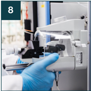
将平台滑入离子源支架，并将离子源安装到您的质谱仪上。
