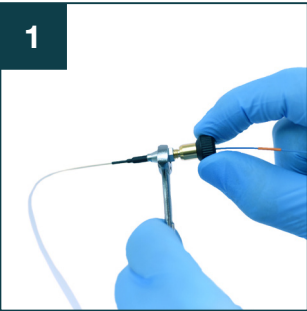
1 用扳手夹住 nanoZero®, 然后用手拧紧 nanoViper 接头, 直到拧不动为止。
