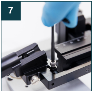
使用 3 毫米六角扳手，通过位于色谱柱支架旁边的角度调节螺栓，根据需要调节色谱柱的角度。
