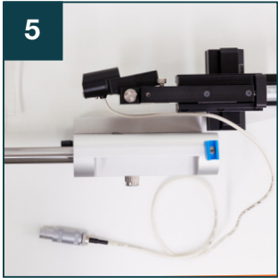
确保高压电缆位于离子源的后部，在两条平台导轨之间。
