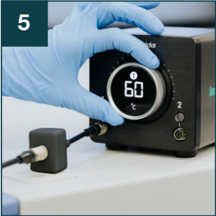
顺时针/逆时针方向转动旋转触摸拨盘, 以设置所需的色谱柱温度。
