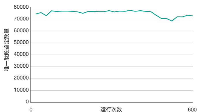
图 1: 从超过 600 次进样序列中收集的 HeLa QC 运行 (100 ng) 的唯一肽段鉴定结果。样品在耦合至 nanoElute2 UHPLC 系统的 Bruker timsTOF HT 上进行分析。原始数据使用 Spectronaut v20.2 处理。
