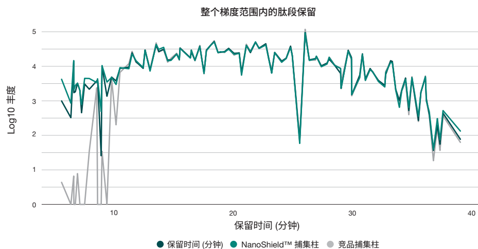
图 3: NanoShield™ 捕集柱在整个色谱梯度范围内提供了优异的肽段保留能力。将直接进样与连接了 Aurora® Ultimate™ (25 cm × 75 μm) 色谱柱的 NanoShield™ 捕集柱及竞品 C18 捕集小柱进行对比, NanoShield™ 捕集柱完全保留了早洗脱肽段, 而这些肽段在竞品捕集小柱上则发生了丢失。
